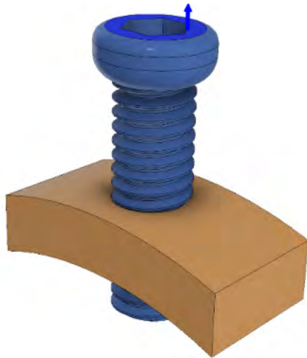
Рис. 1. Модель гвинта АО діаметром 3,5 мм та сегмента кортикального шару. Стрілкою вказано напрямок навантаження
