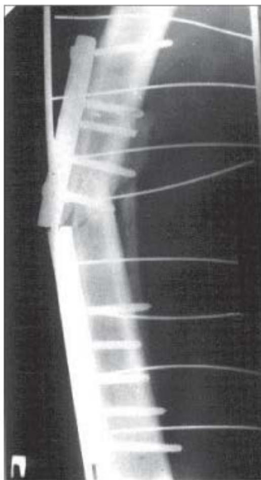
Рис. 2. Зруйнування накісткової пластини.
