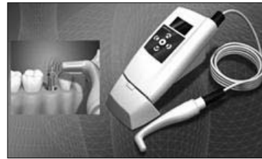
Рис. 14. Апарат для частотно-резонансного тестування інтеграції імплантата в кістці – "Ostel".
