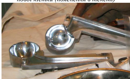
Рис. 6. Прес-форма для інтраопераційного виготовлення спейсера
